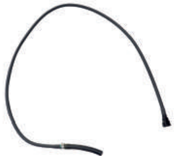
کد کالا: ۱۵۵-۵۲۲۴ شیلنگ بنزین برگشت از از ریل سوخت
